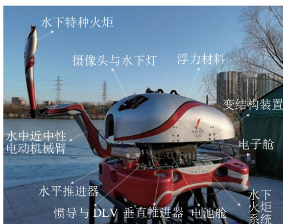
图5 水下变结构机器人系统组成
