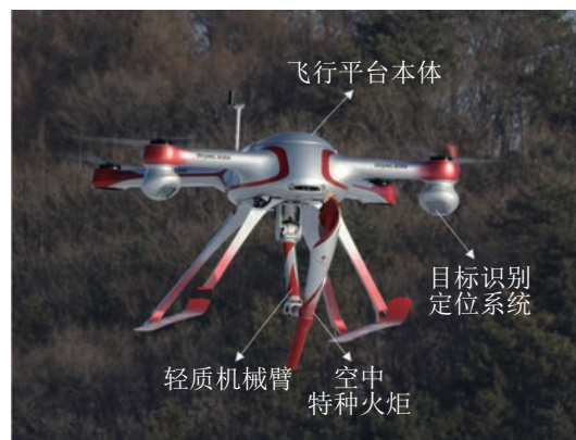
图7 空中飞行机器人及系统组成
